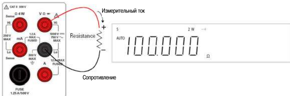
Рис. 2-10 Иллюстрация измерения сопротивления и "прозвонки" цепи в двухпроводной схеме
