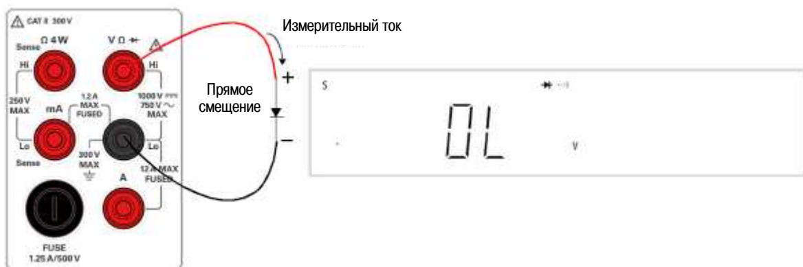
Рис. 2-8 Иллюстрация проверки диода при прямом смещении
