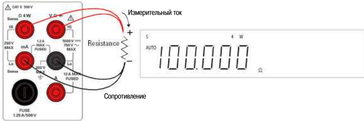
Рис. 2-7 Иллюстрация измерения сопротивления в четырехпроводной схеме
