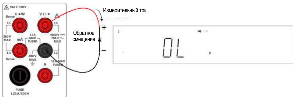
Рис. 2-9 Иллюстрация проверки диода при обратном смещении
